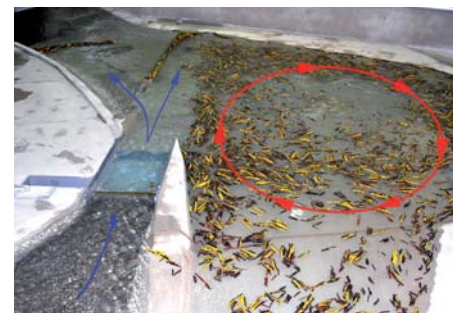
Bild 9. Situation nach einem EHQ mit der gewählten Bestvariante: angedeutet sind die «Hauptströmungsrichtungen» und die Rezirkulationszone im Holzrückhaltebereich.
