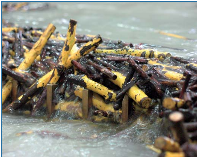
Bild 8. Auftürmen des Schwemmholzes am V-förmigen Holzrechen während eines HQ 100 -Ereignisses. Links: Während des Versuchs Nr. 5 (Blick gegen die Strömungsrichtung); rechts: Messung der Wasserspiegellage vor dem Holzrechen während des Versuchs Nr. 9.
